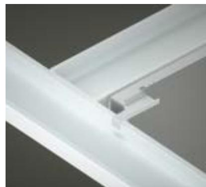
Le crochet Flying Arm est fixé à l'aile verticale du panneau. L'accès s'obtient en poussant le bord opposé du panneau vers le haut. Le panneau coulisse vers l'arrière pour dégager l'aile et s'abaisse en position verticale (« soulever et basculer »).
