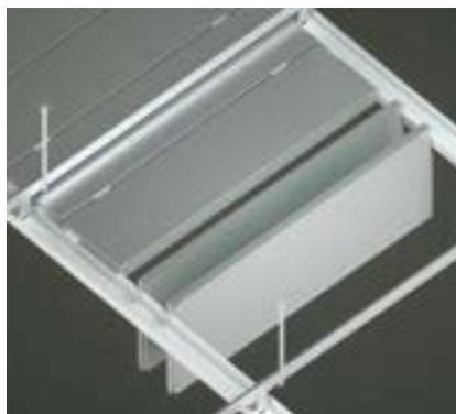
L'encoche latérale permet de suspendre les bacs verticalement aux profilés C pour un accès parfaitement dégagé au plénum. On peut ainsi suspendre les séries de bacs les uns contre les autres lors des interventions d'entretien sans risquer de les endommager.
